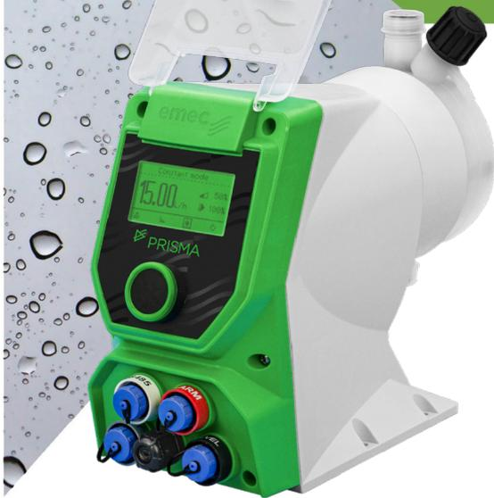
Die Schrittmotor-Membrandosierpumpe PRISMA ist für Anwendungen konzipiert, die hochpräzise Dosiermengen und zuverlässige Wiederholbarkeit erfordern. Dank des mikroprozessorgesteuerten Schrittmotors und der hervorragenden Schrittauflösung von 1: 4800 wird der gesamte Hub- und Saugzyklus präzise gesteuert. Maximale Dosierfrequenz 180 Schritte/Minute.
